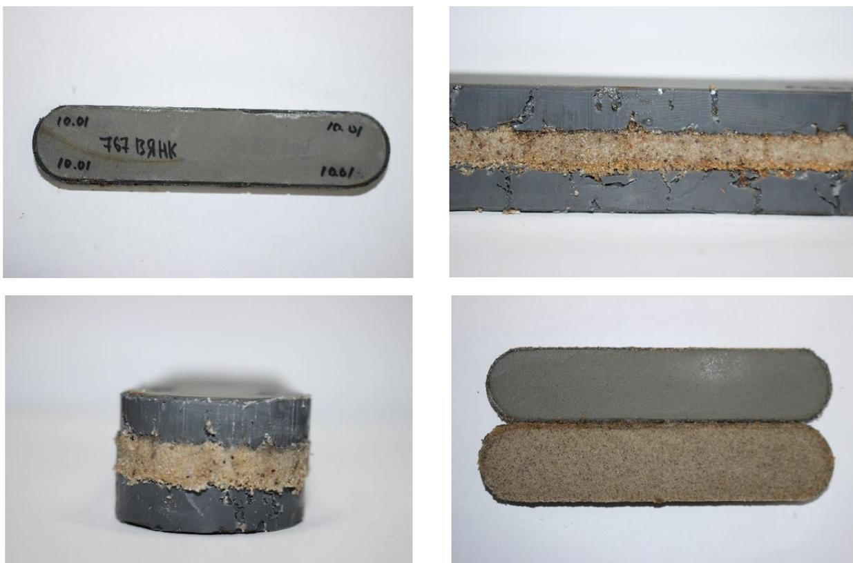
Рисунок 6 – Проба пропанта после испытания базовой проводимости
