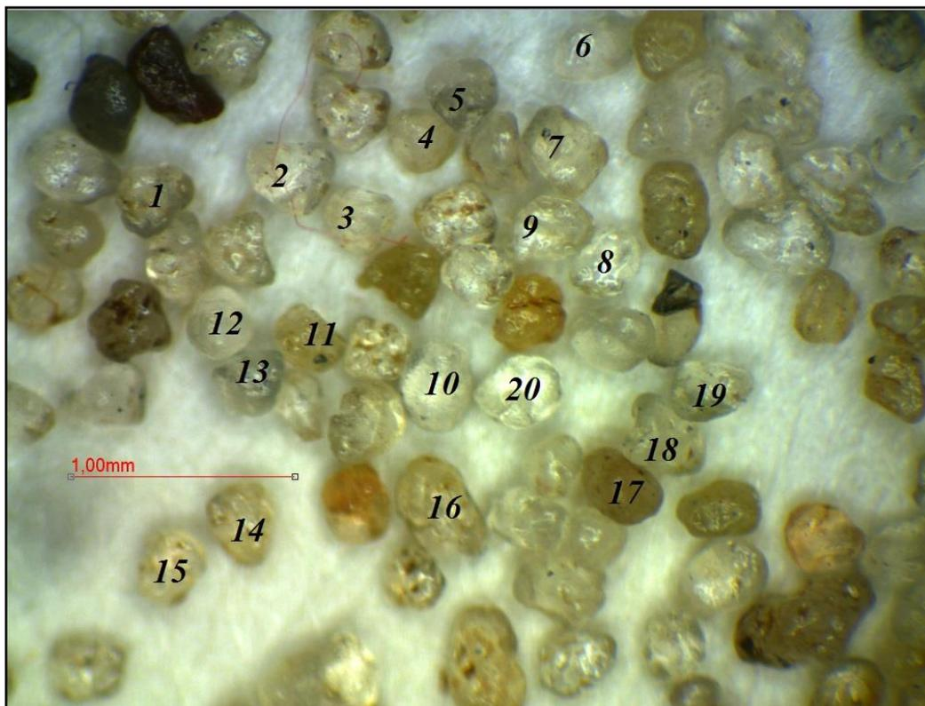
Рисунок 5 – Проба пропанта для измерения сферичности и округлости
